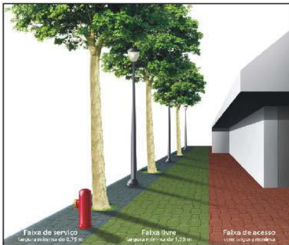
Figura 1. Desenho da Calçada - Dimensões Mínimas Fonte: Guia Prático para Construção de Calçadas - CREA-BA/2007
